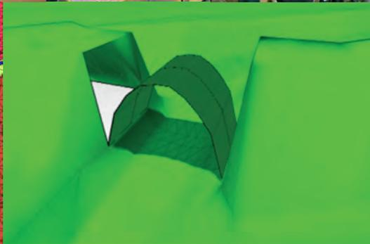
*Links: Hydrotec entwickelt die Modellierung mit gemischten Netzen kontinuierlich weiter. HydroAS 6.1 bietet einen verbesserten KUK-Ansatz für die Modellierung von Abflüssen in Durchlässen.*
