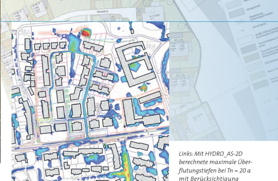
Links: Mit HYDRO\_AS-2D berechnete maximale Überflutungstiefen bei  $T_n = 20$  a mit Berücksichtigung der Kanalisation (Skala 1 cm (blau) bis 20 cm (gelb))
