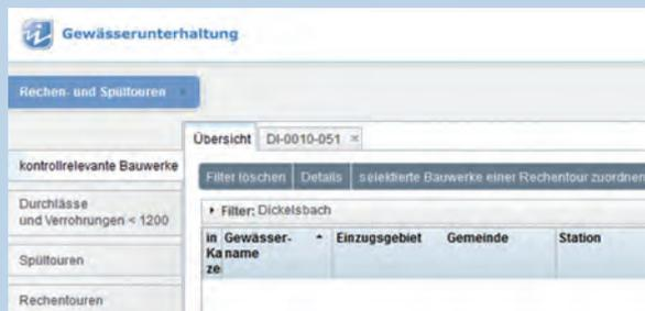
Abb. 3: Rechen- und Spültouren für kontrollrelevante Bauwerke lassen sich mit dem GWU-Modul detailliert planen und dokumentieren.
