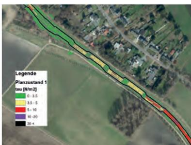
Die aktuelle Jabron-Erweiterung zeigt insgesamt eine gute Übereinstimmung mit den 2D-Ergebnissen in Gewässermitte, während die Werte am Uferbereich insgesamt etwas geringer ausfallen.
