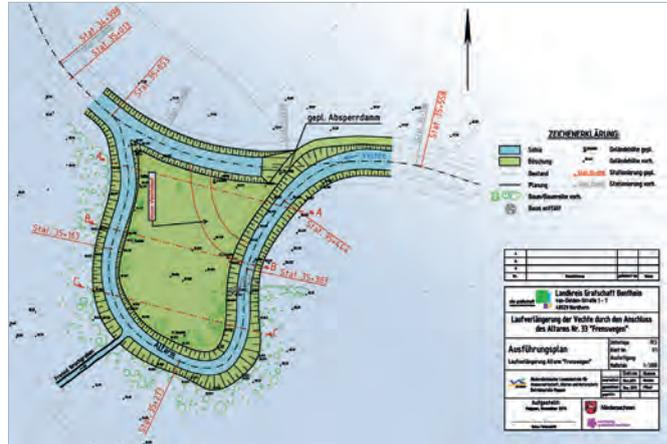
Zum Ausführungsplan für den Anschluss des Altarms Frenswegen an die Vechte lieferte Hydrotec die hydraulischen Berechnungen.
