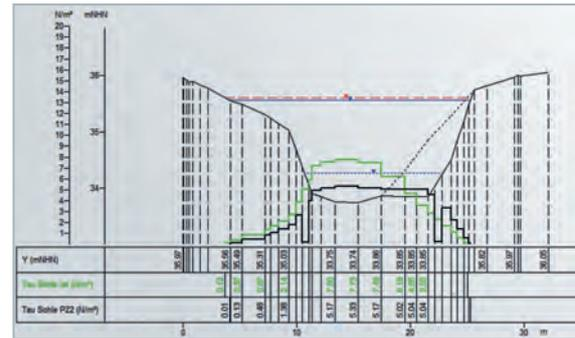
Abb. 4: Ergebnisdarstellung Wasserspiegellagen und Schubspannung Profil 104 Planzustand (PZ) 2 (FKM 90+623)
