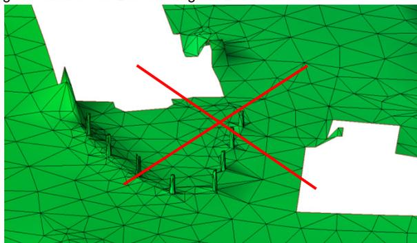
unzureichende Bereinigung der Vermessungsdaten für die Netzerstellung in verschiedenen Modellen
