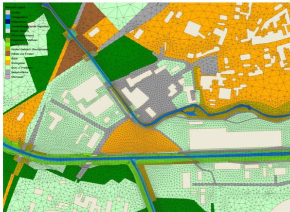
gut strukturiertes Berechnungsnetz des Rödermodells
