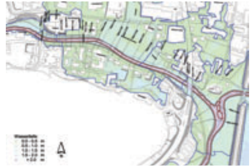
Maximale Fließtiefen im Ist-Zustand, Basis der Variantenrechnung
