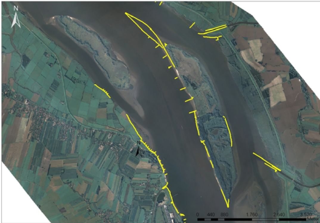
Abb. 2: Pagensand als wasserbaulich festgelegte Insel rechts, der unbefestigte Schwarztonnensand links; gelb: Deckwerke und Bühnen.
