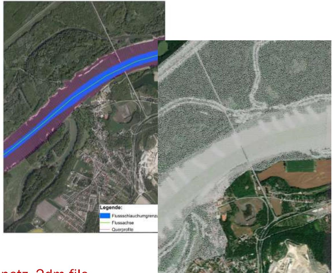
→ Durchgängiges Berechnungsnetz .2dm-file
